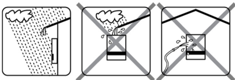
Figura 2.1 Evitare un contatto continuo con acqua
